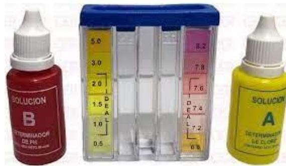
Colocamos en cada vaso el agua del caño, agua mineral y agua con lavandina, luego extraemos con una jeringa y colocamos en el tubo de medición. Agregamos la solución y esperamos. Se repetirá el proceso con los tres tipos de agua.
